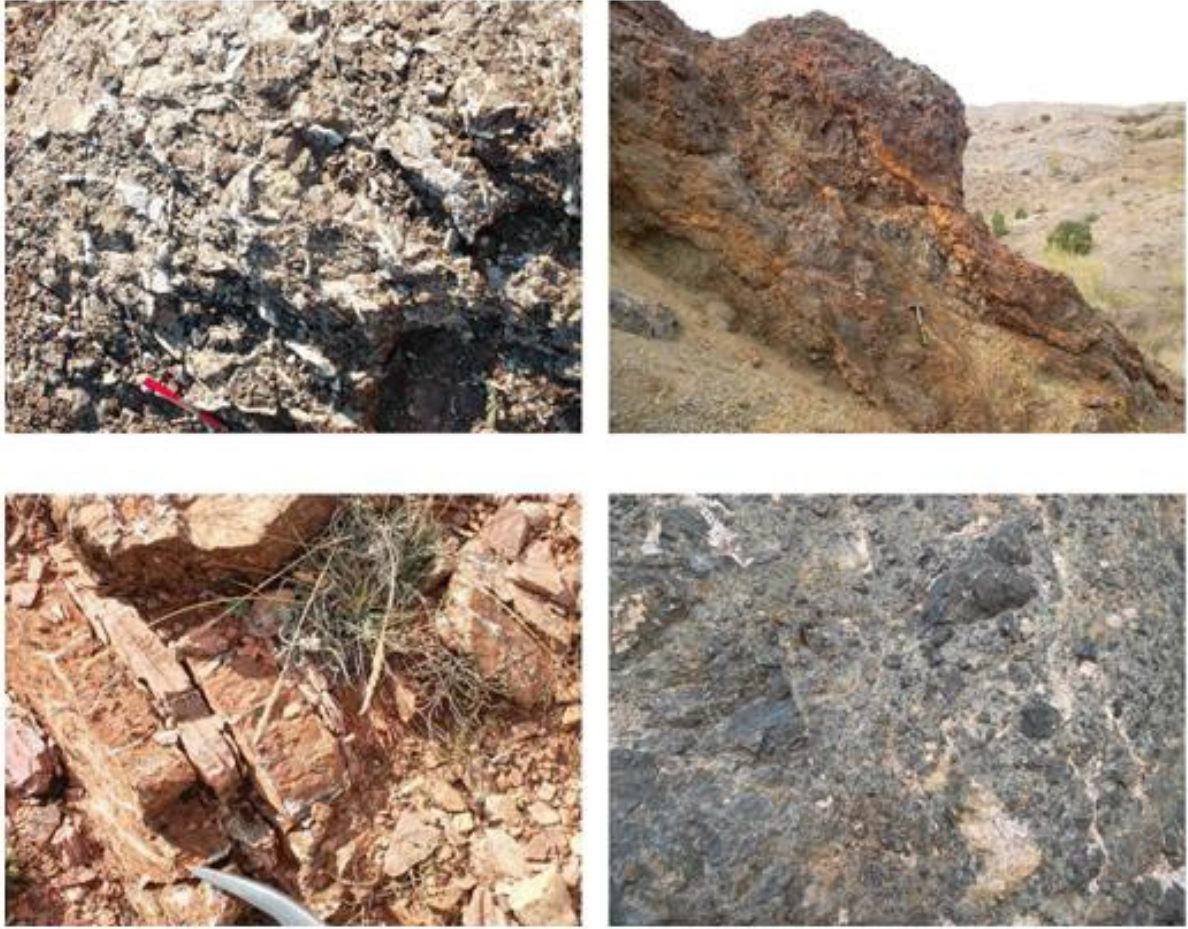
Şekil 7.4 litolojiler gözlemlendi. Sol üst: kalsit stockwork ile yastık bazalt. Sağ üst: gossanous katman. Sol alt: ara katmanlı çört ve karbonat. Sağ alt. Bazaltik breş (Kaynak DMT 2018)
